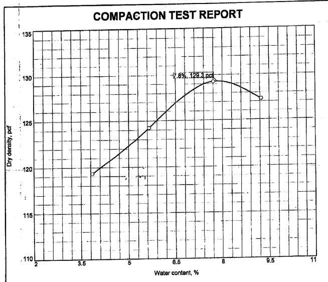
¡Test specification: ASTM D 698-12a Method C Standard
